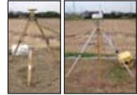
GNSS固定局 / 無線送信機
