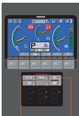
運転モード切り換えスイッチ
