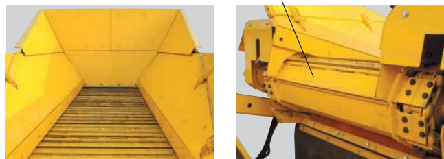
高強度鋼製エプロンフィーダ
