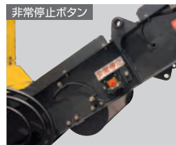
非常停止ボタン
